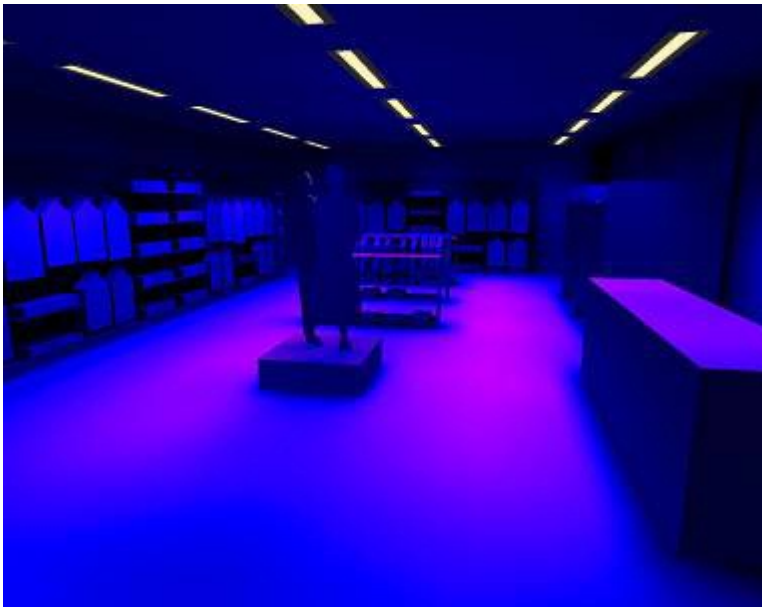
Bildunterschrift: Visualisierung einer Planung eines Shops nach EnEV in Falschfarben. Die hellsten Orte sind der Boden. So will es die Norm.
